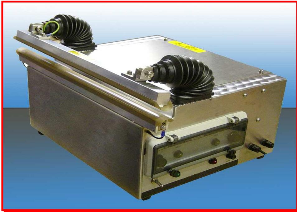
Saldatrice per la chiusura di sacchetti in plastica, coestrusi o accoppiati leggeri con larghezza fino a cm 40, con struttura a protezione IP54 che la rende indicata per l'utilizzo in ambienti ostili (*protezione totale alla penetrazione di corpi solidi e contro la penetrazione di liquidi da gocce, vapori o spruzzi in qualsiasi direzione*)
